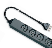
01297.AU 2P+T 16 A; con alette per fissaggio a parete, 4 uscite + interruttore automatico magnetotermico 1P+N C 16 120-230 V~ p.i. 3000 A (08065.16), 2 m cavo 3G1 mm 2 e spina 2P+T 16 A standard italiano S17
