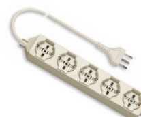
01294 2P+T 16 A; con alette per fissaggio a parete, 5 uscite, 2 m cavo 3G1 mm 2 e spina 2P+T 16 A standard italiano S17
