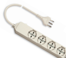
01297.AU 2P+T 16 A; con alette per fissaggio a parete, 4 uscite + interruttore automatico magnetotermico 1P+N C 16 120-230 V~ p.i. 3000 A (08065.16), 2 m cavo 3G1 mm 2 e spina 2P+T 16 A standard italiano S17
