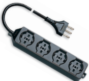
01292 2P+T 16 A; con alette per fissaggio a parete, 4 uscite 2 m cavo 3G1 mm 2 e spina 2P+T 16 A standard italiano S17
