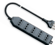
01264 2P+T 16 A; con alette per fissaggio a parete, 5 uscite, 2 m cavo 3G1 mm 2 e spina 2P+T 16 A standard italiano S17
