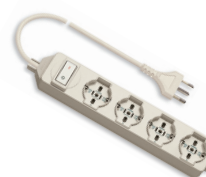
01296 2P+T 16 A; con alette per fissaggio a parete, 4 uscite + interruttore 2P 16 A (08016), 2 m cavo 3G1 mm 2 e spina 2P+T 16 A standard italiano S17
