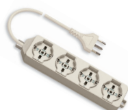
01292 2P+T 16 A; con alette per fissaggio a parete, 4 uscite 2 m cavo 3G1 mm 2 e spina 2P+T 16 A standard italiano S17
