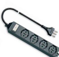
01296.SC 2P+T 16 A; con alette per fissaggio a parete, 4 uscite + SCUDO limitatore di sovratensione e segnalazione d'intervento (08376), 2 m cavo 3G1 mm 2 e spina 2P+T 16 A standard italiano S17
